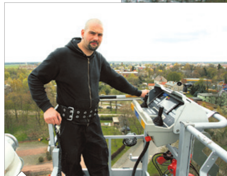
Die kleine Kabine am Leiterende mit Steuerungseinheit.
