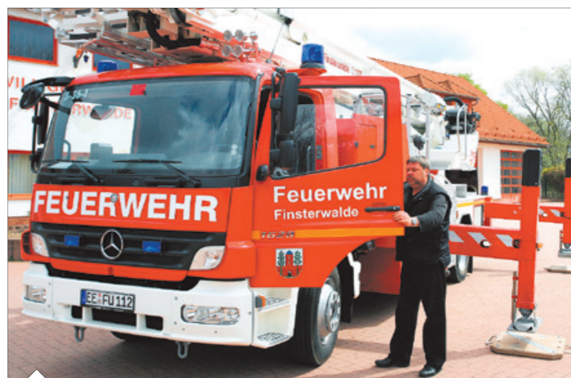
Das Einsatzfahrzeug wird zum Ausfahren der Leiter vorbereitet.
