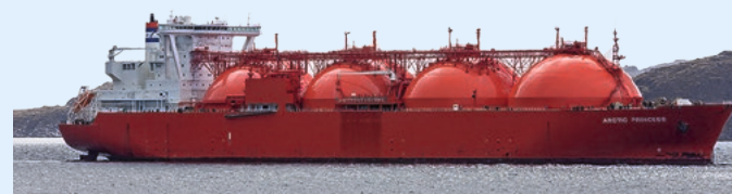
Innen eiskalt, außen hitzebeständig: Zurzeit erfüllen riesige kugelförmige Tanks diesen Anspruch, die wegen ihrer Form jedoch bald von besser händelbaren Konstruktionen abgelöst werden sollen.
