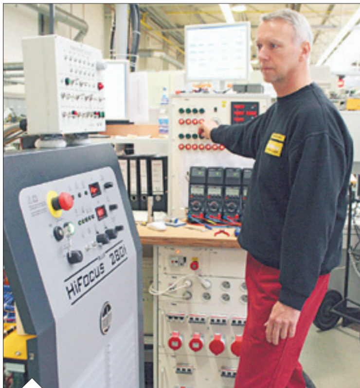
Siegfried Bedranowsky überwacht Belastungs- und Funktionstests an den Plasmaschneidanlagen von Kjellberg.
