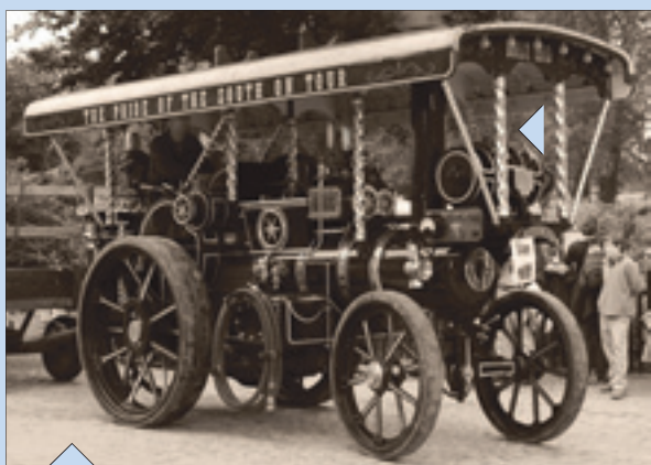
Auf den harten Prärieböden kamen Dampftraktoren, in Europa auch Straßenlokomotiven genannt, häufig zum Einsatz. Der niedrige Wirkungsgrad erforderte jedoch, dass immense Mengen Kohlen und Wasser immer bereitstehen mussten.
